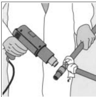
61. ábra: A szétszedendő kötés melegítése
