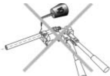
42. ábra: A cső ne legyen olajos vagy zsíros, a toldóhüvelyes kötés létrehozásához ne használjuk kenőanyagot
