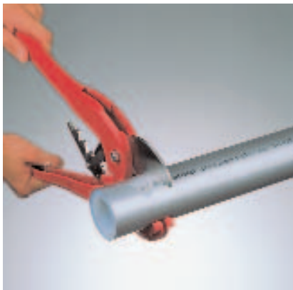
43. ábra: : A csövet a kívánt hosszra levágjuk
