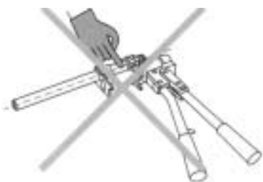
41. ábra: A toldóhüvelyes kötés létrehozásánál nem szabad a préselés zónájába nyúlni.
