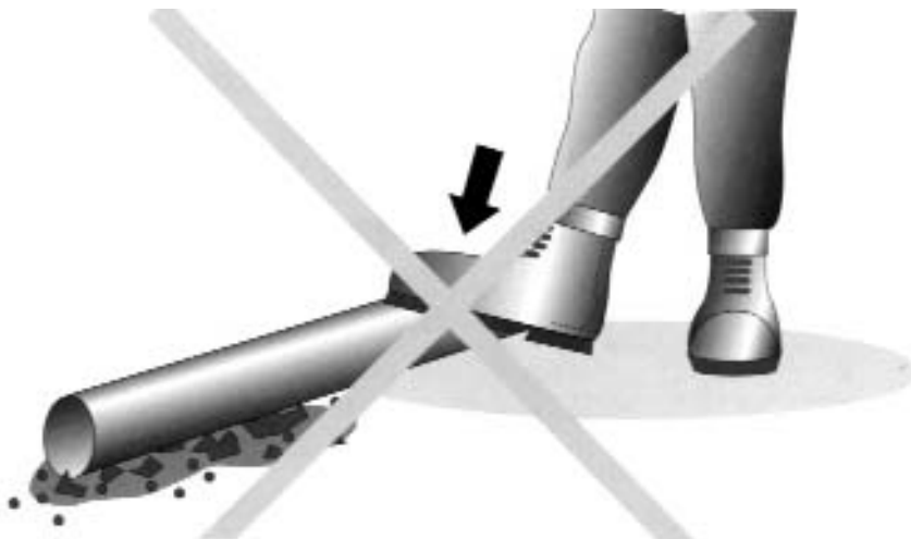
10. ábra: A csöveket nem szabad éles sarkú felületen tárolni
