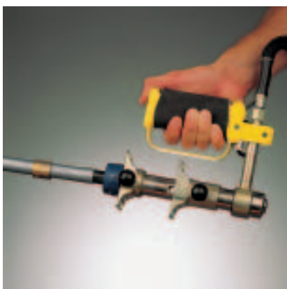
36. ábra: 16/20-as tágítópofo: a csövet kétszer feltágítjuk, a két tágítás között 30°-kal elfordítva. Tágítás közben a toldóhüvely ne legyen a tágítási zónában. A tágítást nem szabad ferdén elvégezni.
