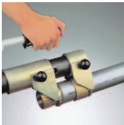
47. ábra: A szerszámfejek közé illesztjük a kötést.
