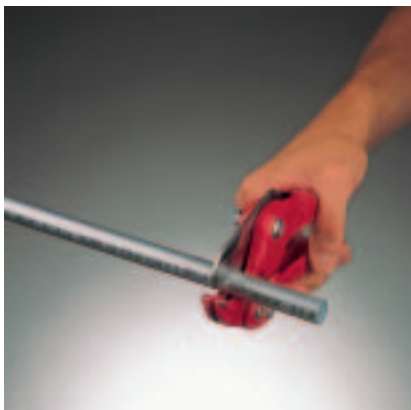
33. ábra: A csövet mérőlegesen a kívánt hosszra levágjuk
