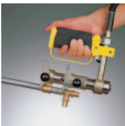
39. ábra: A prészerszámot helyezzük el a kötésnél. A tágítást nem szabad ferdén elvégezni.
