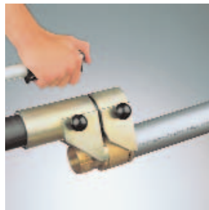
48. ábra: A toldóhüvellyel a szerszám segítségével felpréseljük.
