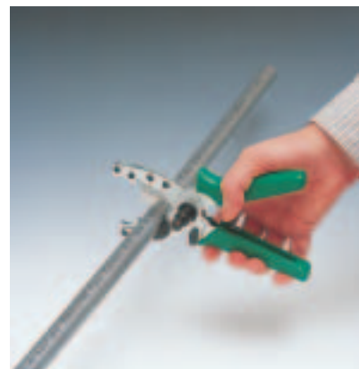
29a ábra: RAUTITAN stabil cső méretre-vágása a 16/20-as RAUTITAN csővágó ollóval (cikksz: 247 474 001)
