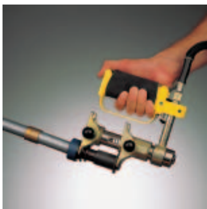
37. ábra: 25/32 tágítóadapter: a csövet kétszer feltágítjuk, a két tágítás között 30°-kal elfordítva. Tágítás közben a toldóhüvely ne legyen a tágítási zónában. A tágítást nem szabad ferdén elvégezni.
