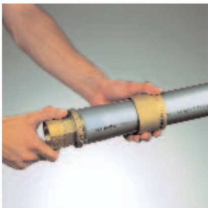
46. ábra: Az idomra ráhúzzuk a csövet. Rövid idő múlva a cső rázsugorodik az idomra (memóriaeffektus)
