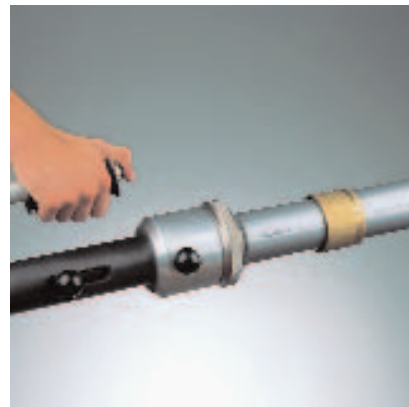
45. ábra: A csövet kétszer feltágítjuk, a két tágitás között 30°-kal elfordítva. Tágitás közben a toldóhüvellyel ne legyen a tágitási zónában.
