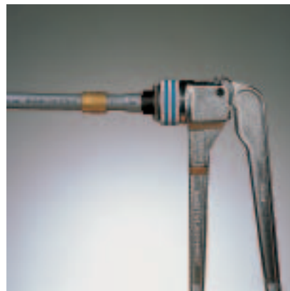
35. ábra: RO kézi tágító-szerszám: a csövet kétszer feltágítjuk, a két tágítás között 30°-kal elfordítva. Tágítás közben a toldóhüvely ne legyen a tágítási zónában. A tágítást nem szabad ferdén elvégezni.
