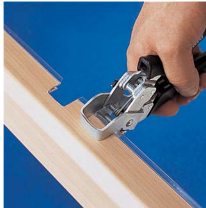
1.2.74. ábra: REHAU fogó a csatorna kivágásához
